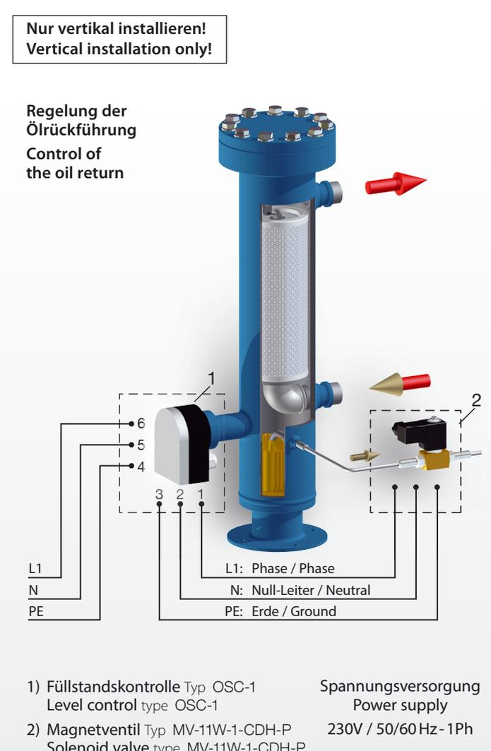
1) Füllstandskontrolle Typ OSC-1
