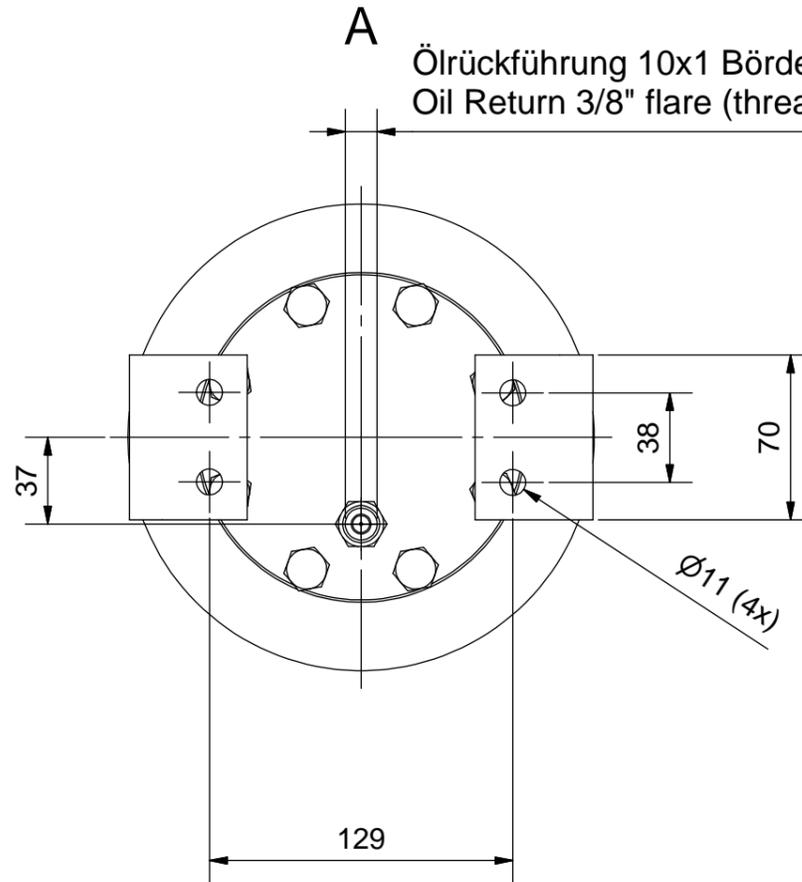
Ölrückführung 10x1 Bördel (Gewinde: 5/8"-18 UNF)
