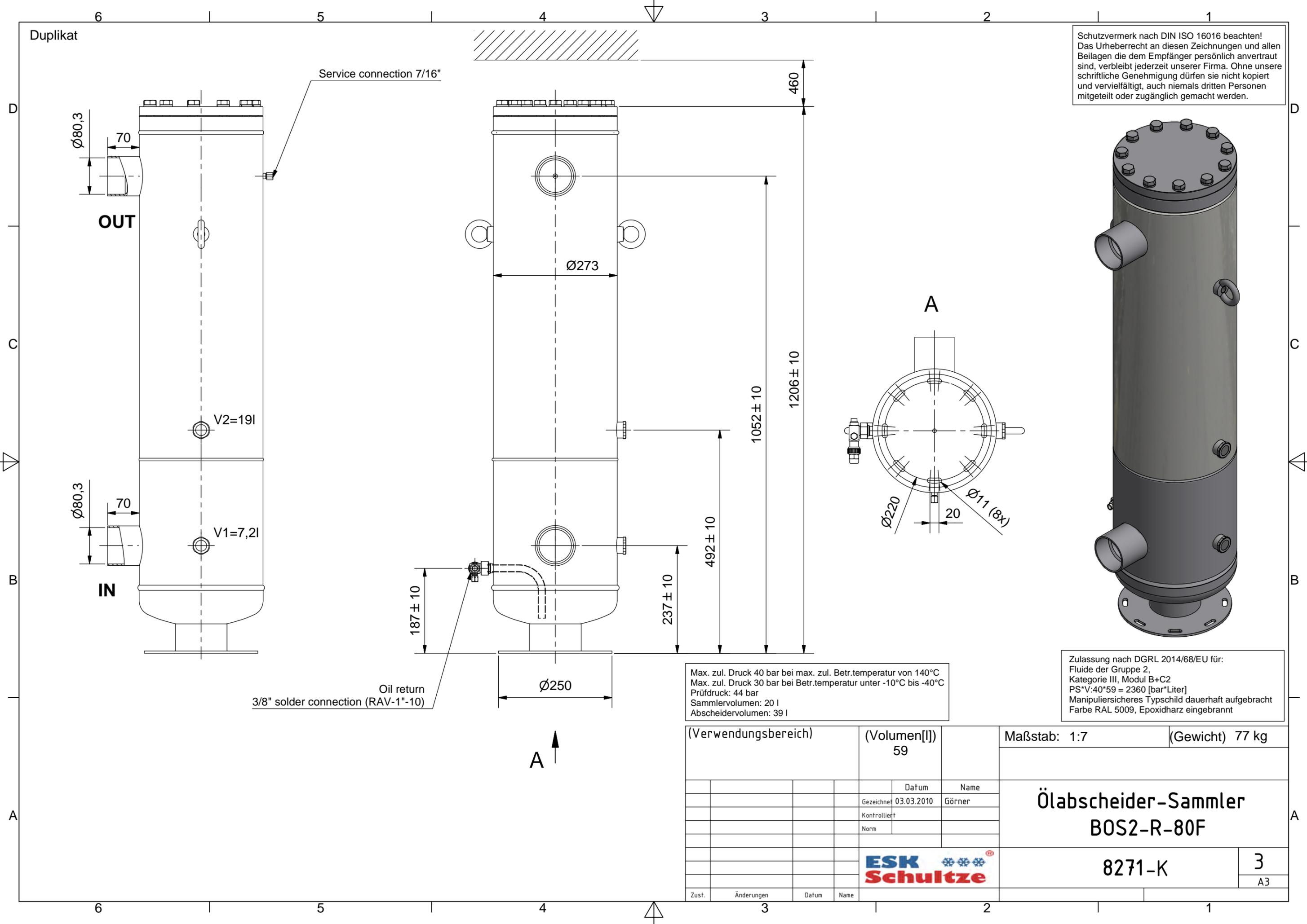
Max. zul. Druck 40 bar bei max. zul. Betr.temperatur von 140°C
