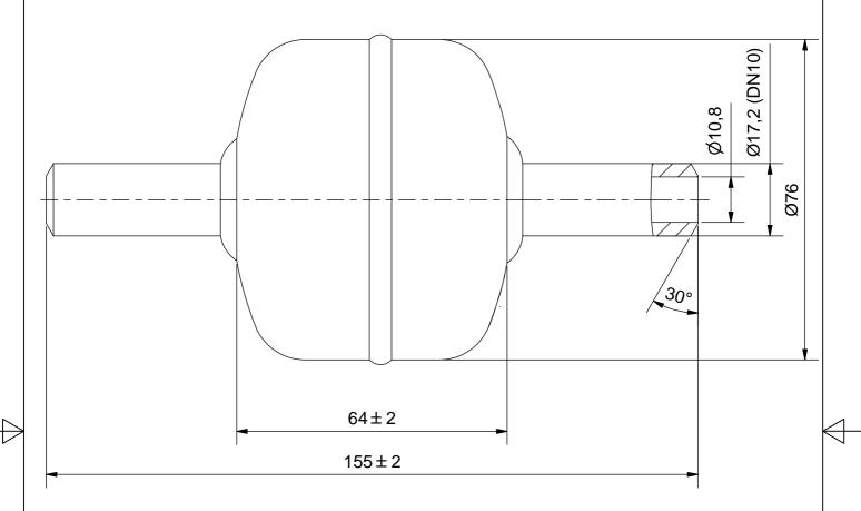
Zulassung nach DGRL 2014/68/EU für: Fluide der Gruppe 2, Artikel 4 Absatz 3, keine "CE" Kennzeichnung PS\*V:60\*0,2=12 [bar\*Liter] Manipuliersicheres Typschild dauerhaft aufgebracht Farbe: RAL 5009, Epoxidharz eingebrannt
